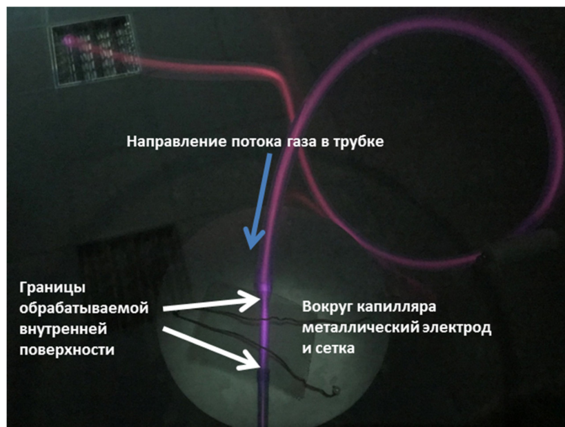
Рисунок 2.24. Обработка полимерного капилляра на установке «ВСИО-20КВ-100НС»
